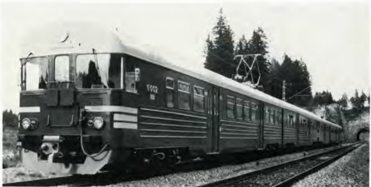
Zweiteiliger elektrischer Triebzug für den Vorort-(S-Bahn-)Verkehr Sm 1, hier als Doppereinheit auf der ersten elektrifizierten Strecke der VR von Helsinki nach Kirkkonummi.
