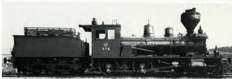
Eine charakteristische finnische Dampflokomotive war die 1Cn2v-Güterzuglokomotive der Reihe Sk 3. Nr. 376 wurde 1901 bei Tampelle in Tampere gebaut.
