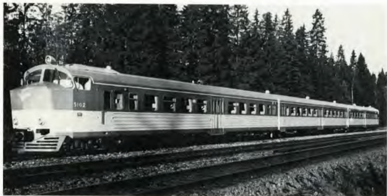
Für den schnellen Reiseverkehr wurden 1963/64 die dreiteiligen Dieseltriebzüge Dm8 und Dm9 von Valmet entwickelt. Sie haben 2 x 550 PS-Breda-Lizenzmotoren, hydromechanisches Schaltgetriebe, 30 Plätze 1. Klasse und 157 Plätze 2. Klasse und einen Speiseraum. Ihre Höchstgeschwindigkeit beträgt 140 km/h.
