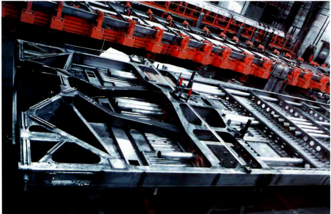
Bild 8: Untergestell aus gekanteten Langträgern und einfachen Querträgern
