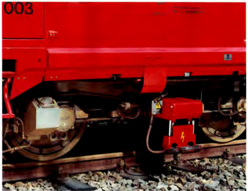
Bild 4: Stromabnehmer; Betriebserprobung der Serienausführung im Prototypzug 480 003
