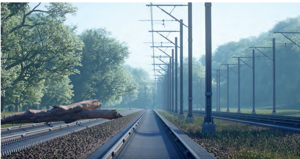
Bild 1: Simulation einer irregulären Situation im photorealistischen digitalen Zwilling. Ein Baum ist umgestürzt und liegt auf dem Nachbargleis (Quelle: NVIDIA, DB Netz AG)
