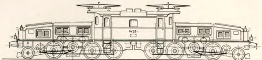
Bild 3. Be 4/6-Lokomotive Nr. 12302 der SBB (SLM und BBC)
