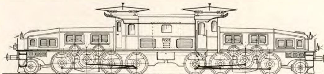
Bild 4a. Be 6/8-Lokomotive der Serie 13251 der SBB (Typenskizze wie 14251) (SLM und MFO)
