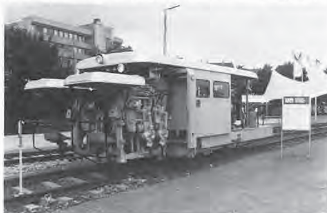
Bild 6: Erste Weichenstopfmaschine – WE 275 –
