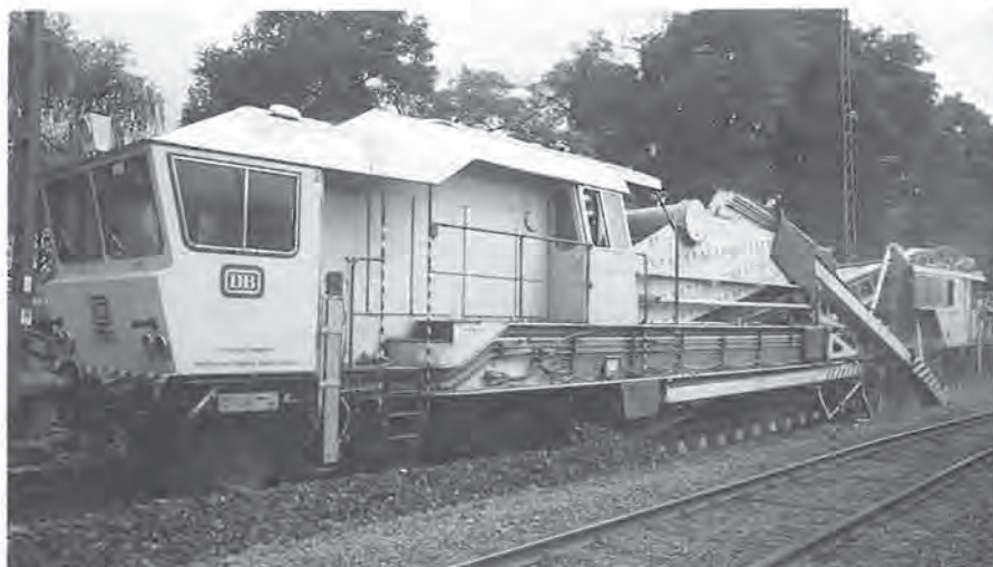
Bild 8: Hochleistungs-Bettungsreinigungsmaschine RM 80 – Baujahr 1980
