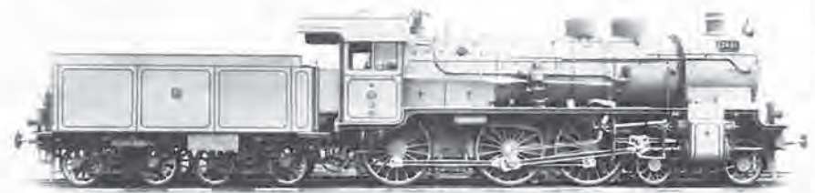
Bild 23: Personenzuglokomotive P 8 der Preußischen Staatsbahn. Diese Universallokomotive, erstmals gebaut 1906, war 1974 noch im Einsatz
