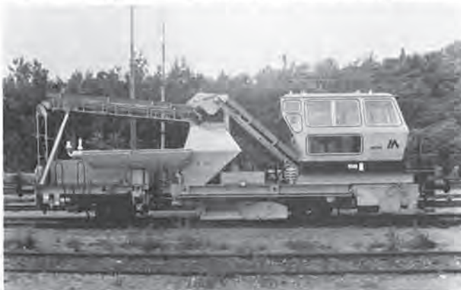
Bild 9: Schotterverfüll- maschine für Gleise und Weichen
