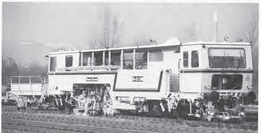
Bild 7: Kontinuierlich vorfahrende, voll elektronisch gesteuerte Zweischwellen-Stopfmaschine 09-32 CSM
