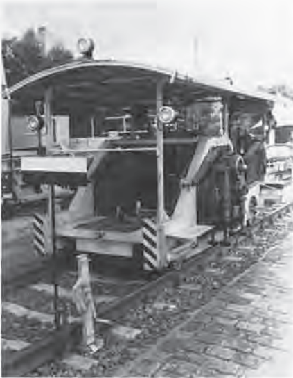
Bild 5: Erste gleisfahrbare Einschwellen-Stopfmaschine
