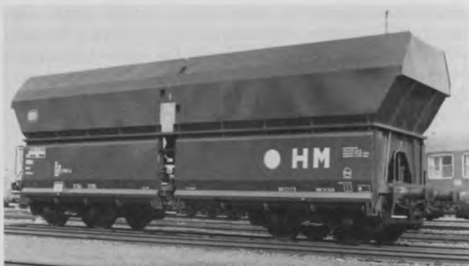
Bild 4: Offener Selbstentladewagen mit Sätteln, Seitenklappen und magnetisch gesteuerter hydraulischer Klappenbetätigung Fals 180
