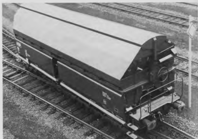
Bild 5: Selbstentladewagen mit Sätteln, Seitenklappen, Schwenkdach und mechanischer Klappenbetätigung Tals 968
