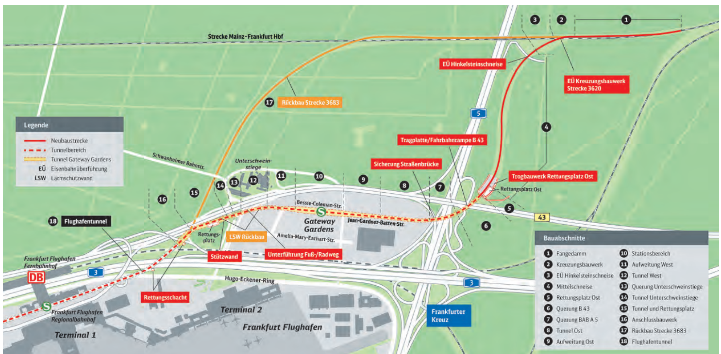
Streckenführung S-Bahn-Anbindung Gateway Gardens
