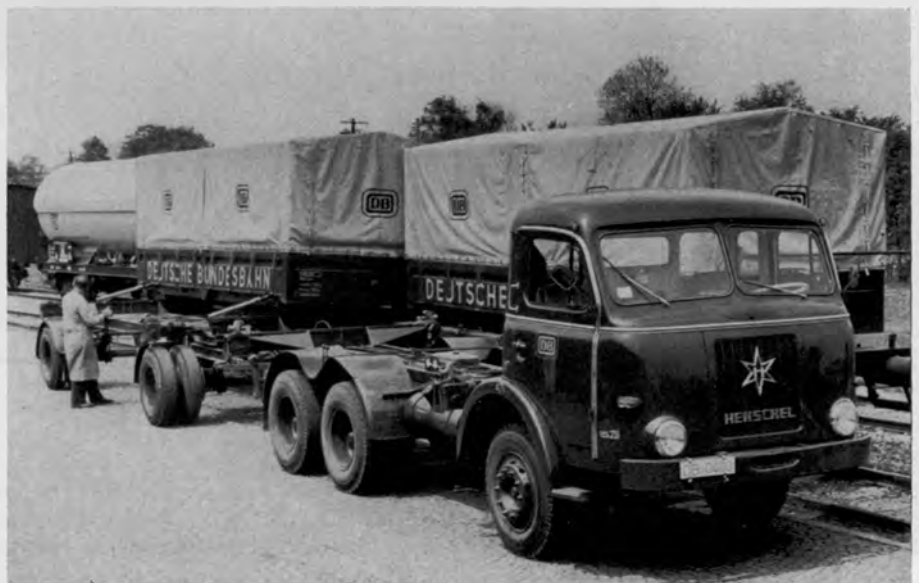
Bild 6. Huckepackverkehr in moderner Kombination von Schiene und Straße mit eleganter Überladung von 2 Wechselkästen für je 10 t Nutzlast des Lastzuges „Wuppertal“ mittels Hydraulik auf einen Eisenbahnwagen. Lastzug „Ulm“ verwendet einen 20 t Wechselkasten und einen Sattelaufleger
