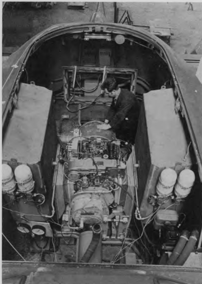
Bild 4: Blick von oben auf die Gasturbinenanlage des Triebwagens 602
