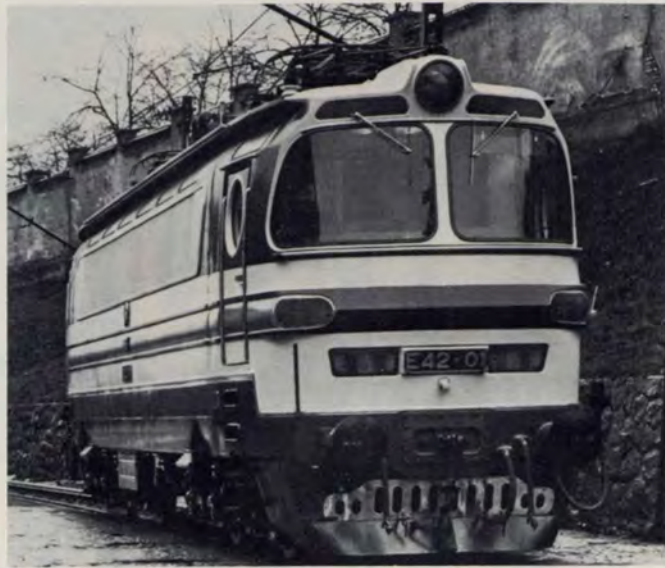
Bild 1: Elektrische Streckenlokomotive E 42 der Bulgarischen Staatsbahnen (BDŽ), gebaut von Škoda, Pilsen.
