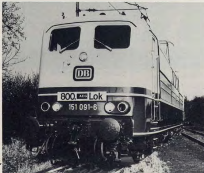
Bild 2: Schwere sechssachsige Güterzuglokomotive Baureihe 151 der Deutschen Bundesbahn; 800. Bundesbahnlokomotive, für die AEG-Telefunken seit 1945 die elektrische Ausrüstung gebaut und montiert hat.
