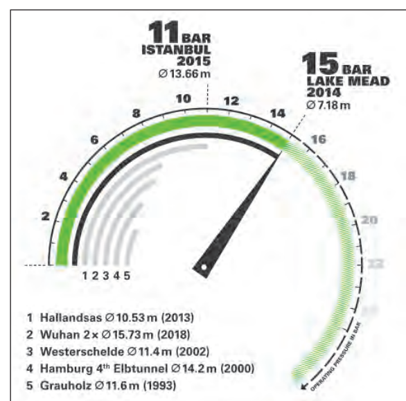
Bild 3: Herrenknecht Tunnelbohrmaschinen kommen mit technischen Entwicklungen dem Bedarf an Tunnelbau in größerer Tiefe und unter höherem Grundwasserdruck nach.
