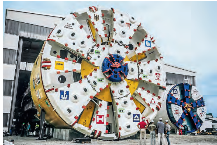
Bild 2: Der Herrenknecht-Tunnelbohrer TRUDE für die 4. Elbtunnelröhre in Hamburg setzte Maßstäbe für den Großdurchmesser-Tunnelbau.
