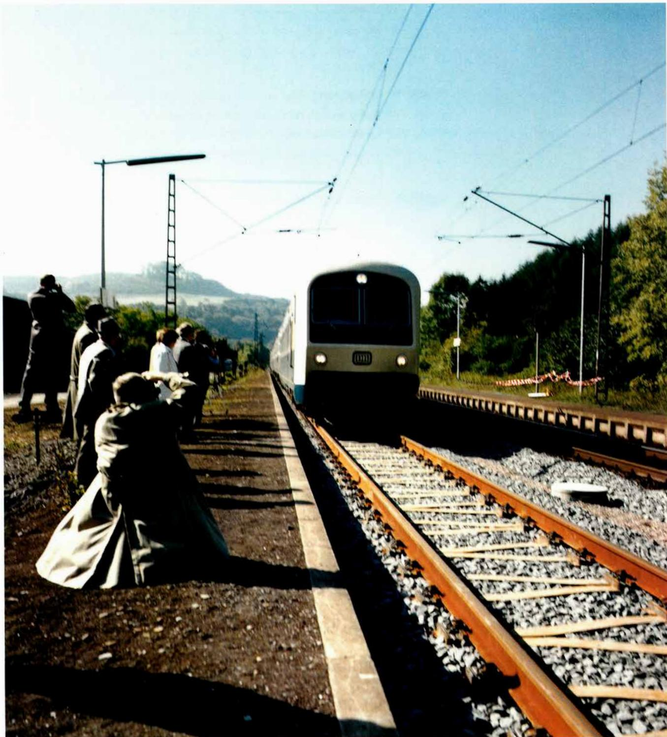
Zugfahrt auf einer DB-Strecke auf Y-Stahlschwellen bei Welsede am 20.09.1986
