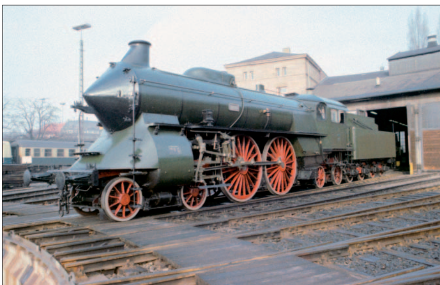
Bild 5: Die schnellste Lokomotive der deutschen Länderbahnen, die bayerische S2/6, erreichte am 2. Juli 1907 154,5 km/h Reisegeschwindigkeit vor einem 150-Tonnen-Wagenzug [3]
