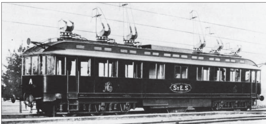
Bild 3: Der AEG-Drehstrom-Triebwagen fuhr am 2. Oktober 1903 einen Weltrekord von 210,2 km/h [3]
