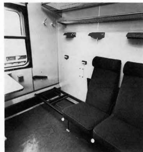
Bild 11: Blick in das Behinderten-Abteil des Reisezugsonderwagens der NSB mit ausgebautem Sitz für den Rollstuhl
