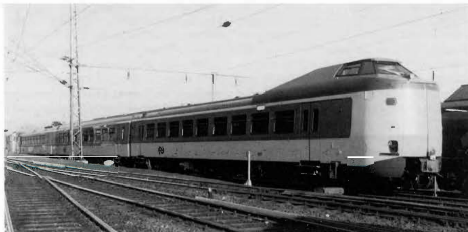
Bild 9: Dreiteiliger elektrischer Triebwagenzug IC III der NS
