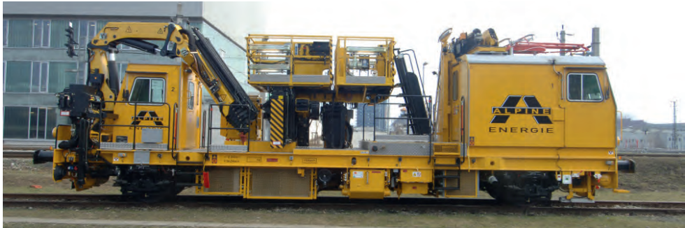
Abb. 5.3: Beispiel – zweiachsige Maschine mit dreigeteilter Säulenhebebühne, Kran, Manipulatoren, Messtechnik (Foto: Autor)
