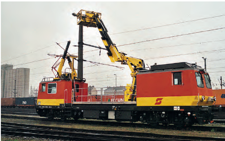
Abb. 5.5: Beispiel – Drehgestellmaschine mit frei schwenkbarer Hubarbeitsbühne, Manipulatoren, Messtechnik (Foto: Autor)
