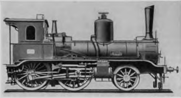
1 B-Schnellzuglokomotive der Westfälischen Eisenbahn mit Heusinger-Steuerung. Gebaut 1875 von Henschel & Sohn, Kassel
