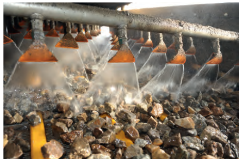
Abb. 3.11: Schotterwäsche in einer Reinigungsmaschine (Fotos: Plasser & Theurer)
