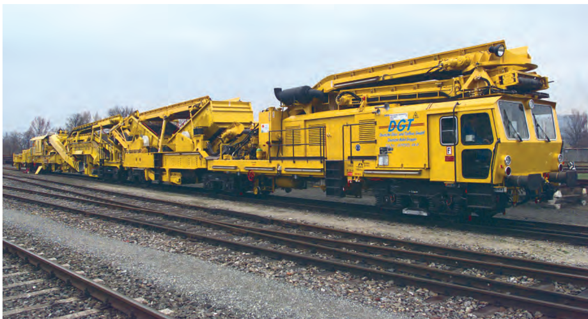
Bild 1: RM 801 DGT Hochleistungs- Bettungs- reinigungs- maschinen mit Vortriebsge- schwindig- keiten von 300 m/h
