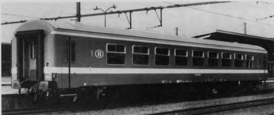
Bild 1: Außenansicht des 24,26 Meter langen Reisezugwagens 1. Klasse der SNCB
