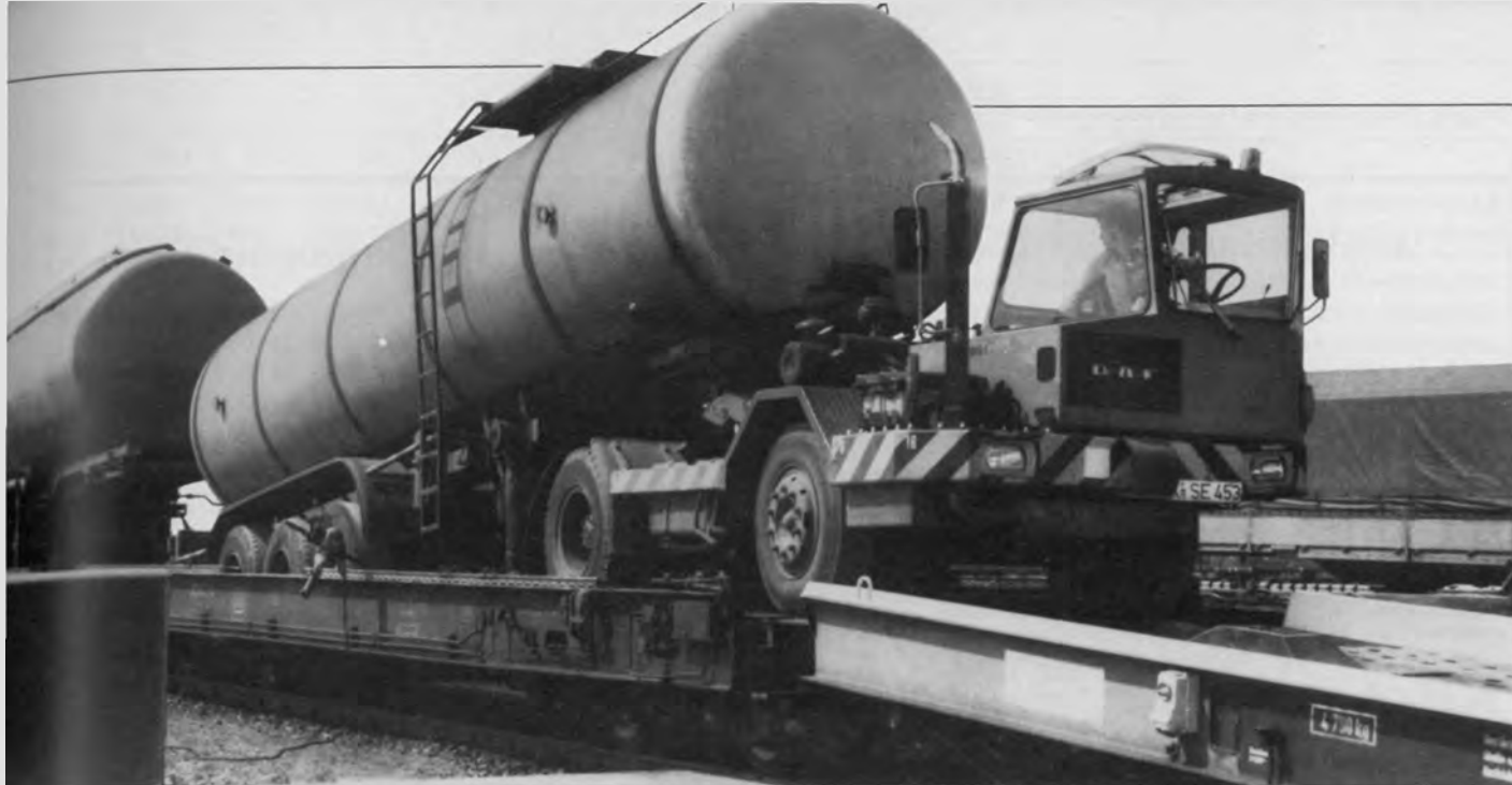
Sattelaufleger werden durch Auffahren rückwärts auf den Wippenwagen verladen.
