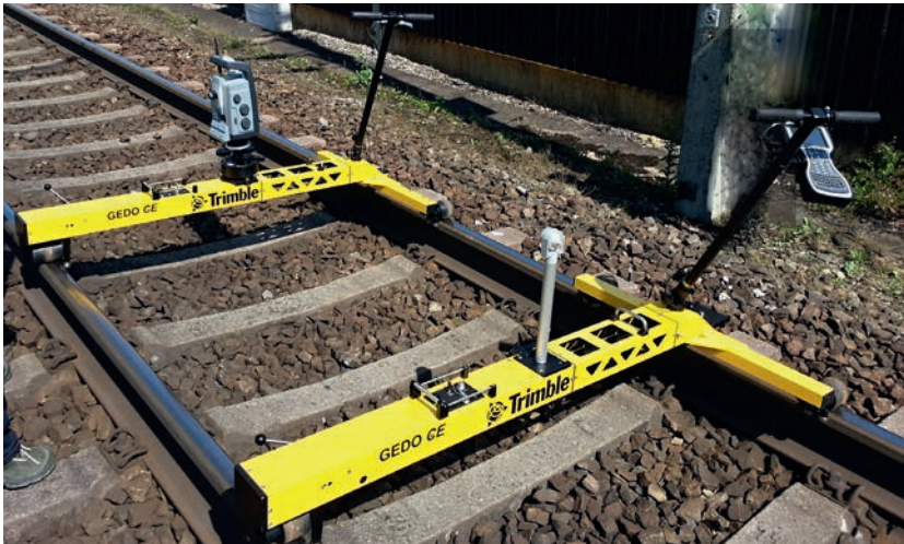
Abb. 4-45: Beispiel für ein handgeführtes Zwei-Wagen-Messsystem
